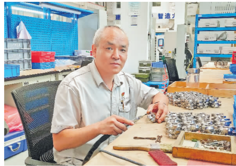
杨峰在对阀门零件进行“精雕细琢”，手工去除机械加工后残存的毛刺。
