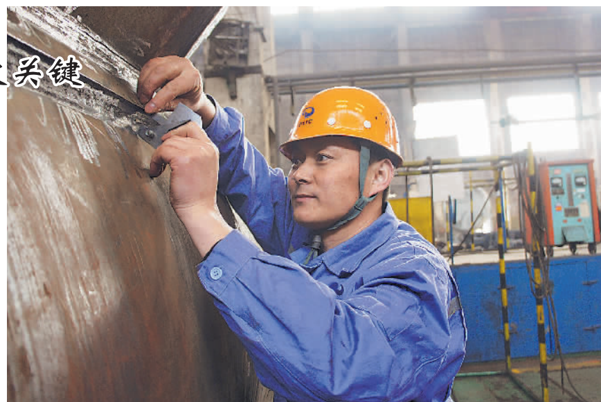
朱先波正在检测焊脚尺寸。
